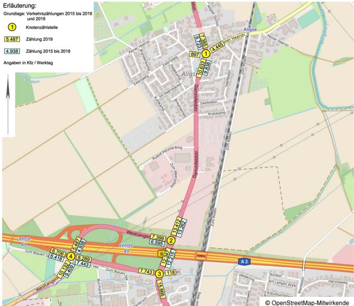
Bild 2: Zählergebnisse 2019 und 2015 bis 2018: Tagesbelastung [Kfz/Werktag]
