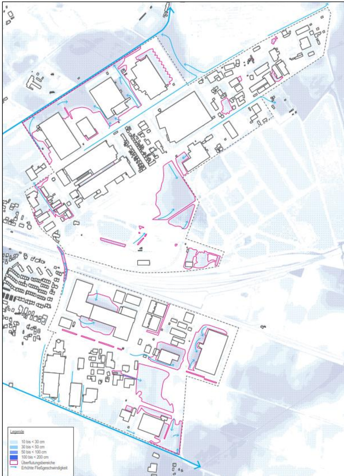
Abb. 2: Überlagerung von Überflutungstiefen, Fließgeschwindigkeit und -richtung ergeben Gefahrenbereiche bei einem extremen Starkregenereignis/ Bundesamt für Kartographie und Geodäsie, www.geoportal.de (aufgerufen am: 20.05.2025)
