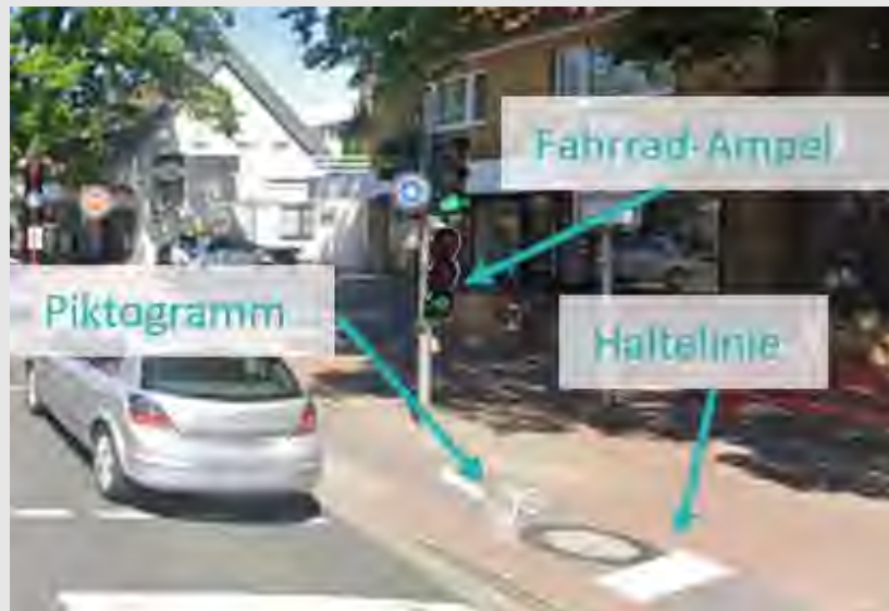
Maßnahmenvorschlag Trennung Fuß- und Radverkehr Rote Reihe, Quelle: Planersocietät
