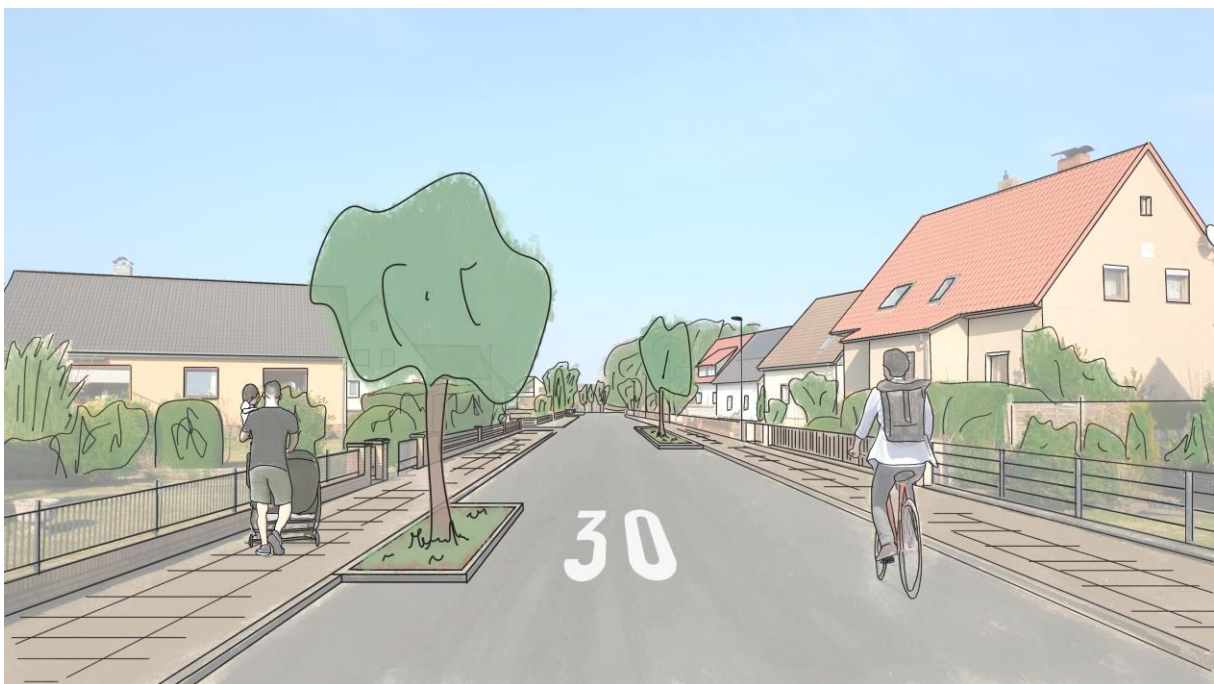
Abbildung 35: Visualisierung einer Fahrbahnverschwenkung durch Bauminself (Variante 1)
